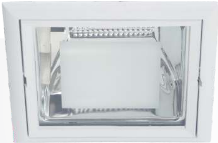
AS 31.80-9 - Embutido Quadrado de Alumínio para 2 Lâmpadas Alt.: 90mm | Nicho: 195x195mm | Diâmetro: 230x230mm Soquete 2xE-27 | Lâmpada: Econômica 20W
