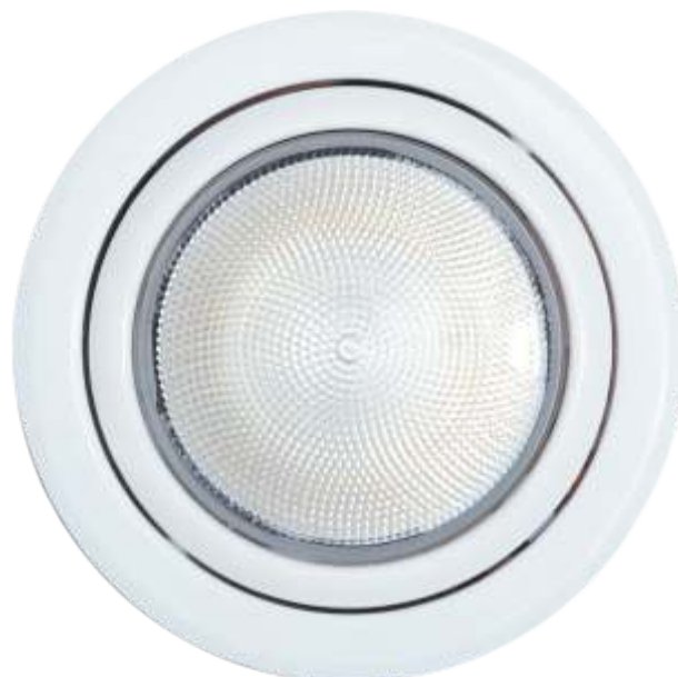
6030 - Embutido Móvel para PAR 30 Aço Alt.: 102mm | Nicho: 130mm | Diâmetro: 150mm Soquete 1xE-27 | Lâmpada: PAR 30 | LED PAR 30 Cor:
