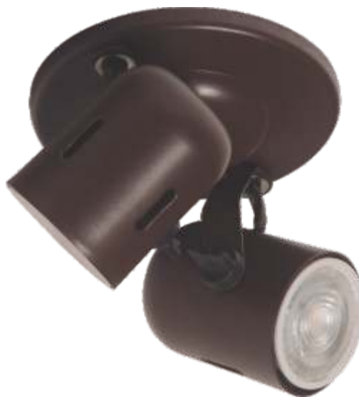
3016/2 - Spot 2 PAR 16 Alumínio Prof.: 115mm | Larg.: 170mm | Alt.: 115mm Soquete 2xGU-10 | Lâmpada: PAR 16 Cor:
