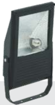
H150C - Projektor Alumínio Injetado HQI com Alojamento Alt.: 350mm | Larg.: 230mm | Comp.: 125mm Soquete Rx7s | Lâmpada: Metálica Duplo Contato 70/150W Cor:
